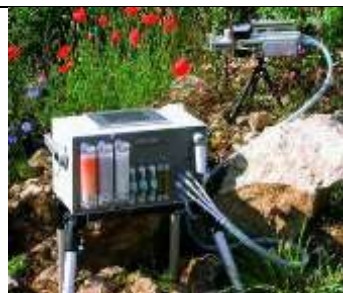
图 7-1 便携式光合-荧光测量系统
