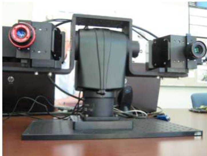
图 0-52 在云台上同时安装有高光谱 SWIR 和 VNIR 成像传感器的实物图
