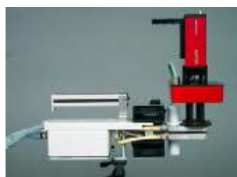
图 7-1 便携式光合-荧光测量系统
