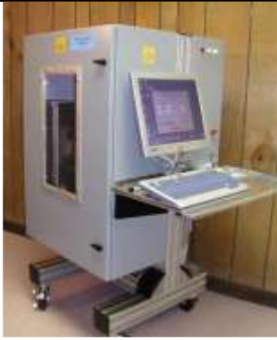
图 7-20 植物根系 X-光扫描成像分析系统
