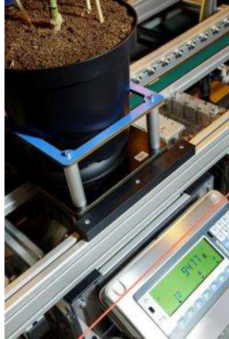
图 0-80 自动灌溉和称重系统的称重工作图
