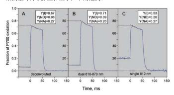
图 7: 三种测量油菜 PSI 互补量子产率 Y(I), Y(ND),Y(NA) 方法比较
