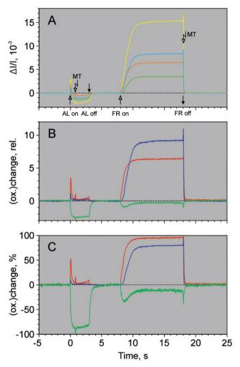
图 2: 常青藤叶片测量与 100%P700, PC, Fd 氧化相关的透射率变化
