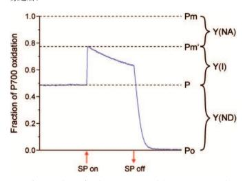
图 6,基于 P700 氧化解卷积变化,使用饱和脉冲法测量 PSI 互补量子产率 Y(I), Y(ND),Y(NA)
