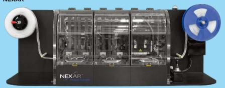
作为超高通量解决方案,该系统可以内联液体处理,用于 阵列卷带上样品和试剂的处理,可提供分液、密封、平板储存 及其它选择性处理功能,如孵化、热循环和脱水干燥等。灵活 的模块化配置,使其可处理各种应用。
